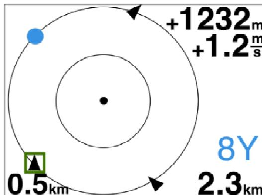
**Figure 7:** Grosse Vergrößerung und weiter entfernte Ziele sind auf dem Rand der Skala dargestellt
