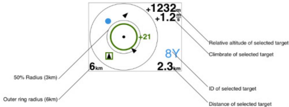
**Figure 6:** Im Radarschirm angezeigte Werte
