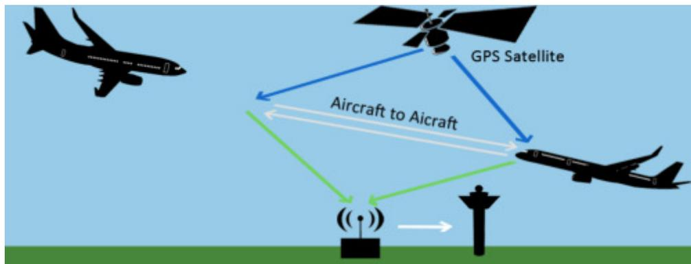
FLARM ist ein in Kleinflugzeugen eingesetztes Kollisionswarngerät, das in der Schweiz ursprünglich für den Segelflug entwickelt wurde und in kurzer Zeit weltweite Beachtung und Verbreitung erfuhr. Es umfasst im wesentlichen einen GPS-Empfänger sowie ein digitales Sende- und Empfangsmodul, welches mittels ADS-B die Position mit anderen Flugzeugen, welche ebenfalls mit FLARM ausgestattet sind sowie mit Bodenstationen (ATC) austauscht.
